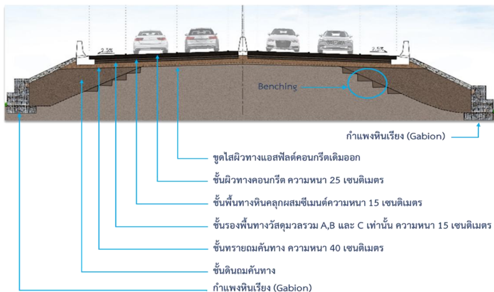
รูปที่ 2.3.2-18 รูปแบบโครงสร้างชั้นทางของโครงการ
